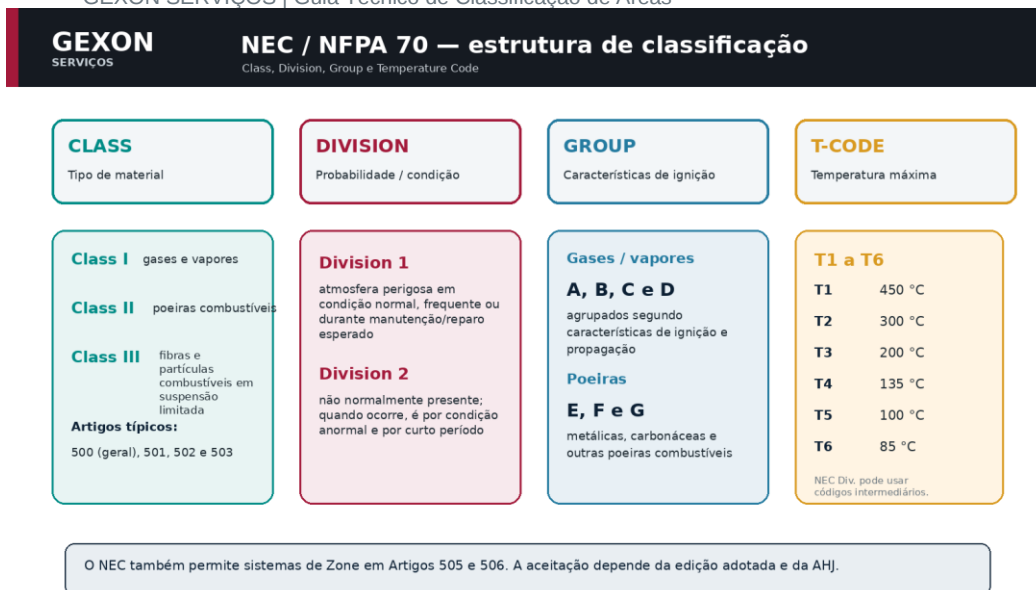
Figura 10 — Estrutura básica de classificação no sistema NEC Class/Division.
