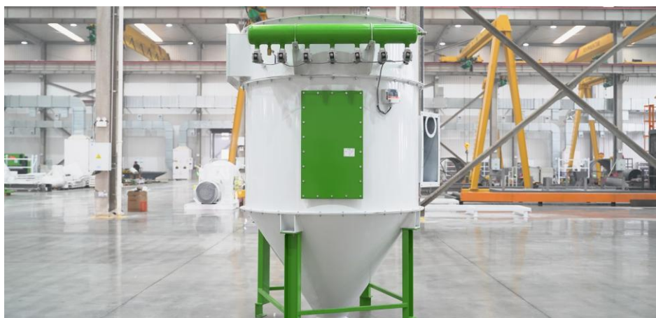
Figura 9 — Equipamento industrial de coleta de poeira. A classificação deve avaliar interior, descargas, flanges, limpeza, vazamentos e camadas. | Foto: RICHI Manufacture, CC BY 4.0, via Wikimedia Commons.
