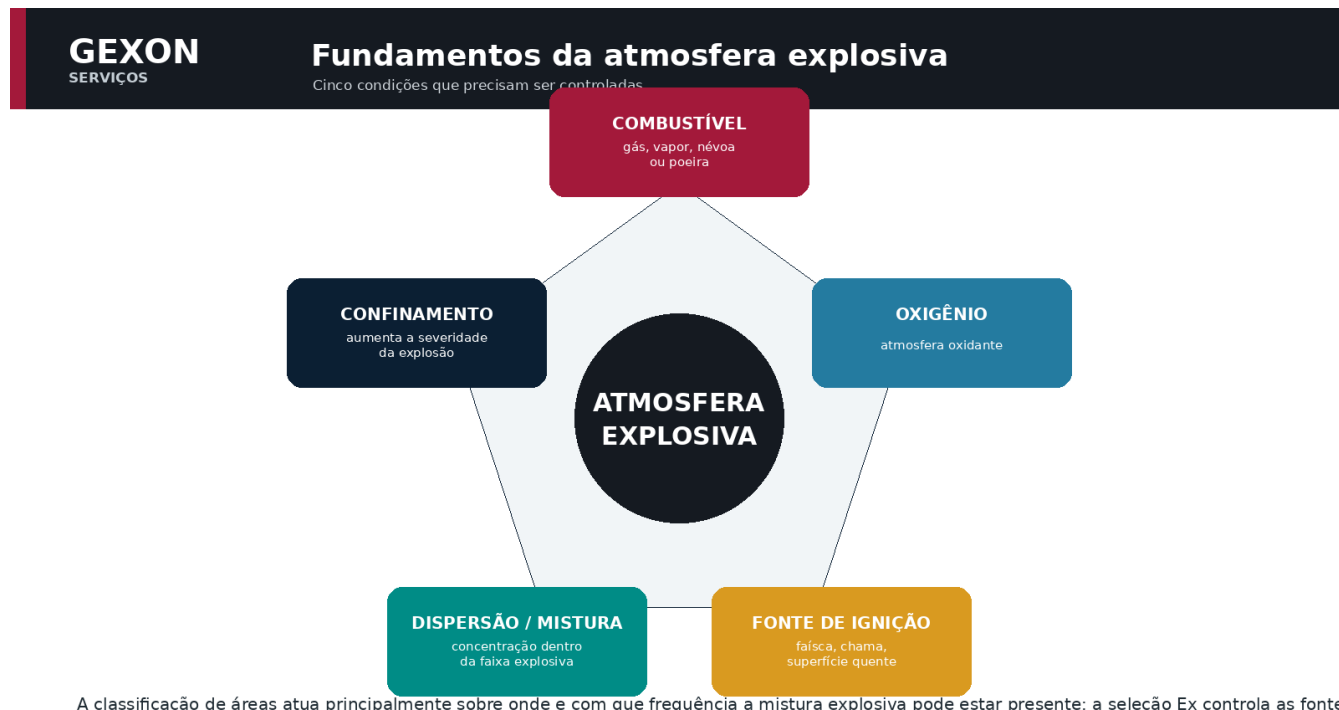
Figura 1 — Condições fundamentais para a formação e severidade de uma atmosfera explosiva.
